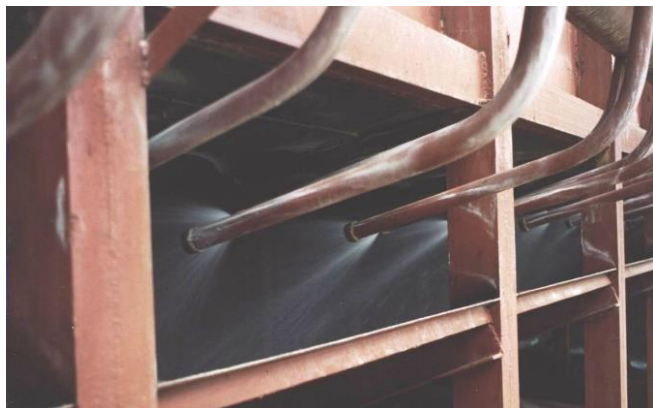
Рис. 2. Система орошения прямоточно-распылительного аппарата для охлаждения оборотной воды
