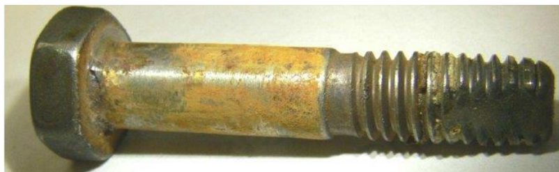
Рис. 1. Внешний вид болта в результате коррозионных повреждений
