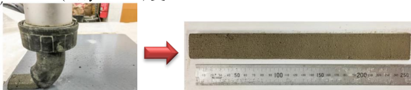
Рис. 4. 3D печать с экструзией под углом 45^\circ
