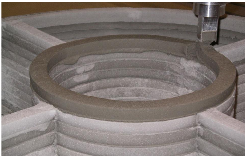
Рис. 3. Качество поверхности при печати на 3D принтере Contour Crafting
