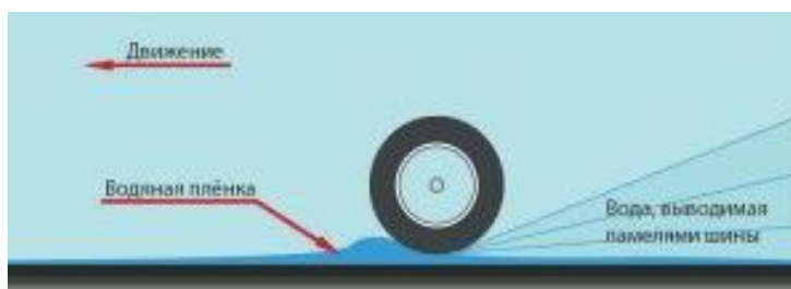
Рис. 1. Схема возникновения аквапланирования [2]
