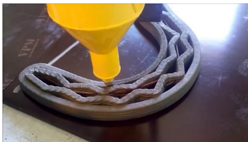
Рис. 2. 3D-печать архитектурного элемента
