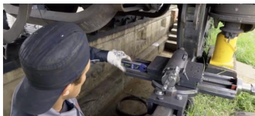
Рис. 4. Мобильный токарный станок для обточки бандажей (колёс) колёсных пар
